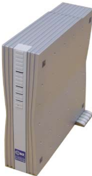
Figura 1. Módem de usuario PLC de DS2 utilizado por Endesa en su proyecto piloto de Zaragoza.
