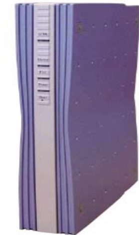
Figura 1. Módem de usuario PLC de DS2 utilizado por Endesa en su proyecto piloto de Zaragoza.
